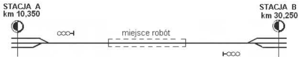
Schemat toru szlakowego jednotorowej linii kolejowej.
